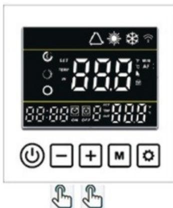
No controlador, pressione **-** ou **+** para ajustar a temperatura desejada da água de sua piscina, em seguida, pressione **⏻** para salvar a configuração.
