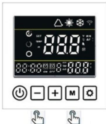
Segure **-** e **M** por 5 segundos e quando a temperatura da tubulação estiver abaixo da temperatura de descongelamento da saída, o sistema estará habilitado para entrar em descongelamento manual.
